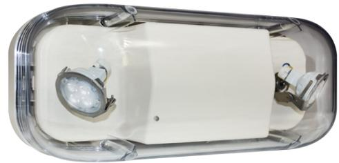
La série d'unités autonomes (à batterie) EBNX est conçue en fonction des conditions d'environnement les plus extrêmes. L'unité, conçue à partir d'un boîtier en polycarbonate, conserve son intérieur scellé au moyen d'un joint d'étanchéité continu intégré. La série EBNX se décline en versions de 6 VCC et 12 VCC, en capacité de 36 W, 50 W, 72 W, 100 W ou 130 W pour une autonomie minimale de 30 minutes en mode de secours. Autotest est standard.
