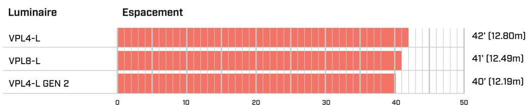
Espacement moyen de 1 luminaire sur 4 normalement allumé dans le chemin de sortie à des hauteurs de montage de 8, 10 ou 12 pieds
